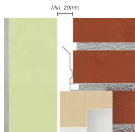
Muröppningsformens rygg är 20 mm djup, erforderligt utrymme måste därför finnas, t.ex. genom en luftspalt eller inskärning i isolering.
