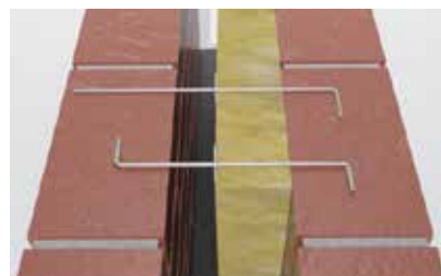
Montage av skalmurskramla nr. 10 i murverkets liggfogar. Horisontalsnitt.
